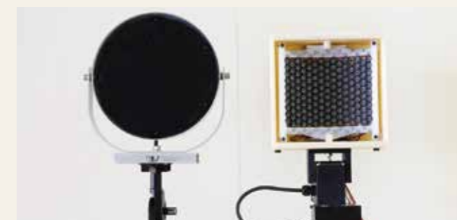
これが世界初の極小領域でのみ音を再生するための超音波スピーカー。文科省革新的イノベーション創出プログラム(COI-T)「運動を生活カルチャー化する健康イノベーション」および立命館大学R-GIRO「多世代交流型運動空間による健康増進研究拠点」の枠組みにて、音像による運動空間シェアリングのコア技術として開発を進めています。
