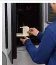
学生が手にしているのは、3Dプリンターでパーツを作り製作したもので、軽く安価な産業用ロボットハンドを研究中。
